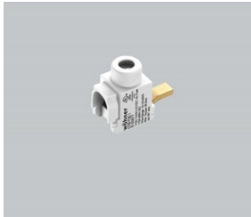
31039 Anschlussklemme, frontaler Anschluss für 31548 6 - 35 mm 2 / AWG 10 - 1/0
