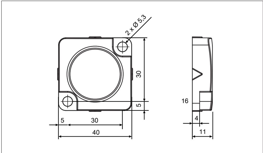
Fig.: Actuator PSEN cs1.1
