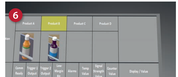
6. Smart-Sensoren weisen neuen Parametersatz für Produkt B auf – Maschine kann gestartet werden
