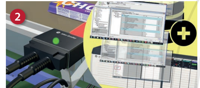
2. Angeschlossen an Logix-Steuerungen über EtherNet/IP und programmiert mit Studio 5000
