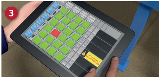
3. ASN-Daten führen den Bediener direkt zum Fehler
