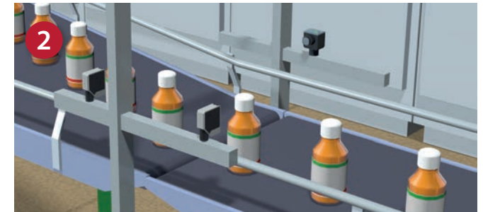
2. Smart-Sensoren am Förderband sind mit Parametern für Produkt A konfiguriert
