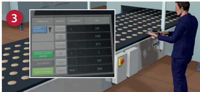
3. Bediener wird über den Sensortyp und seine Position in Echtzeit informiert
